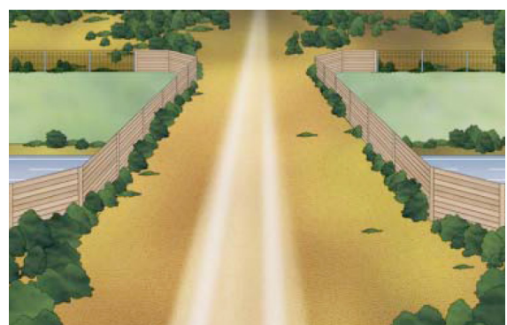
Paso superior de fauna multifuncional
